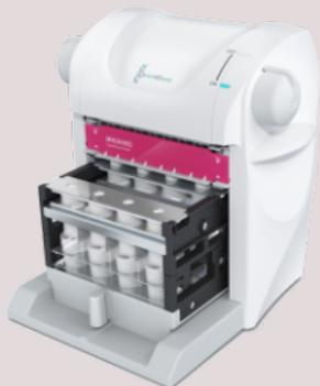
QuickGene-Mini8L ist ein kompaktes, manuell zu bedienendes Gerät zur Präparation von Nukleinsäuren bei geringem bis mittlerem Probendurchsatz. Dieses Gerät bietet Ihnen zusammen mit den entsprechenden Kits die Möglichkeit, Nukleinsäuren aus größeren Blutmengen (bis 2 ml) zu isolieren und damit eine hohe Ausbeute an DNA zu generieren.
