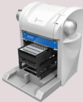
QuickGene-Mini480 ist ein kompaktes, manuell zu bedienendes Gerät zur Präparation von Nukleinsäuren bei geringem bis mittlerem Probendurchsatz. Es ist klein genug, um damit im sterilen Bereich einer Laminarbox zu arbeiten.
